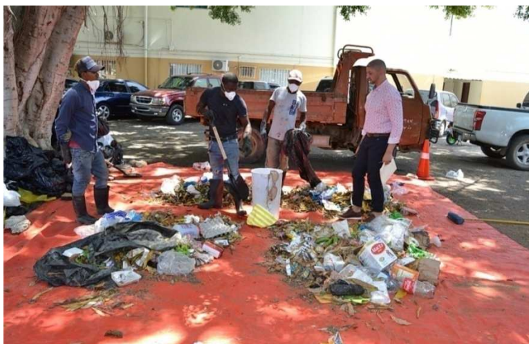
Imagen 4a. Cuarteo y calculo de densidad suelta y compactada.
