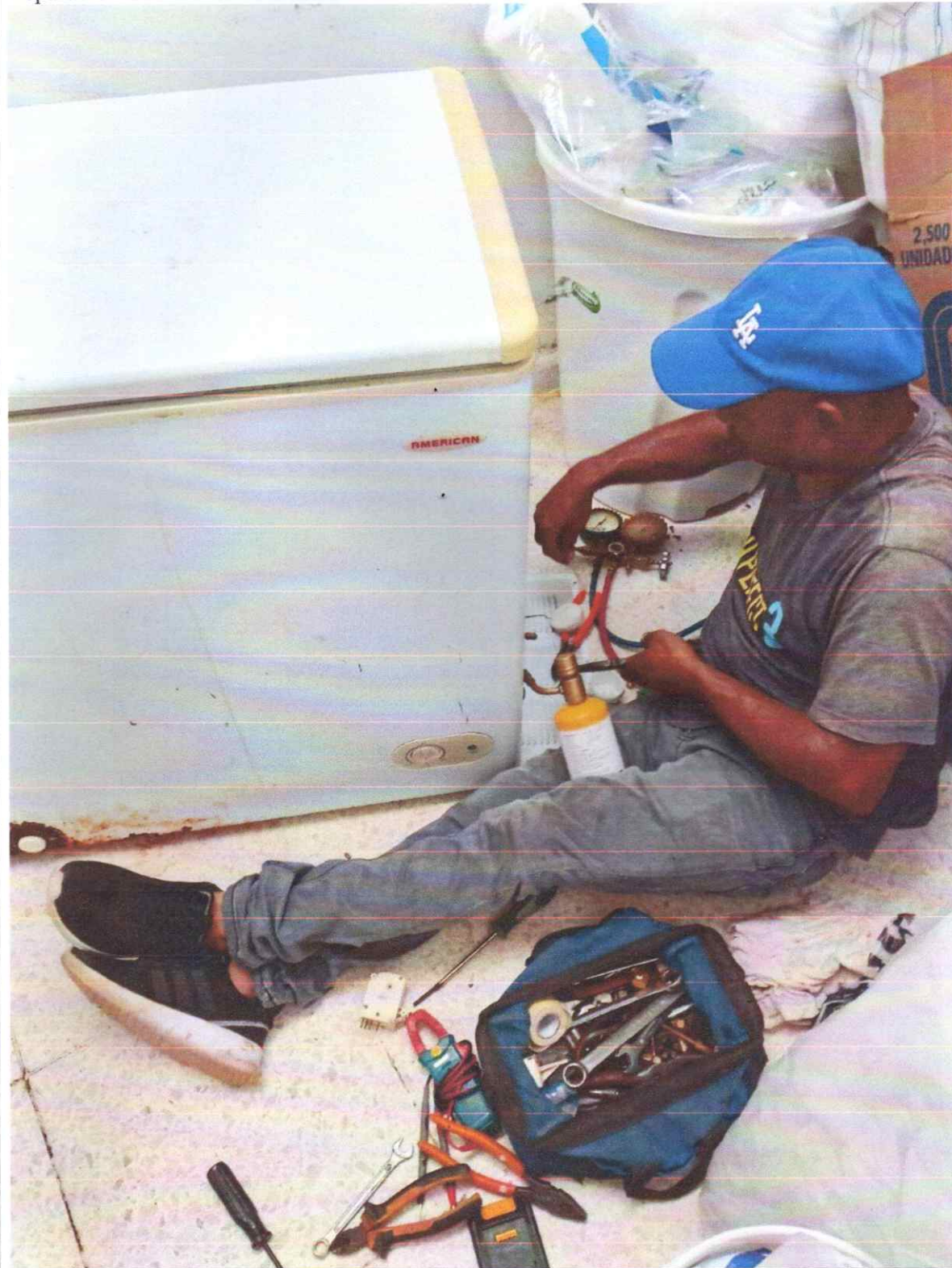
Reparación de Freezer de la Cocina
