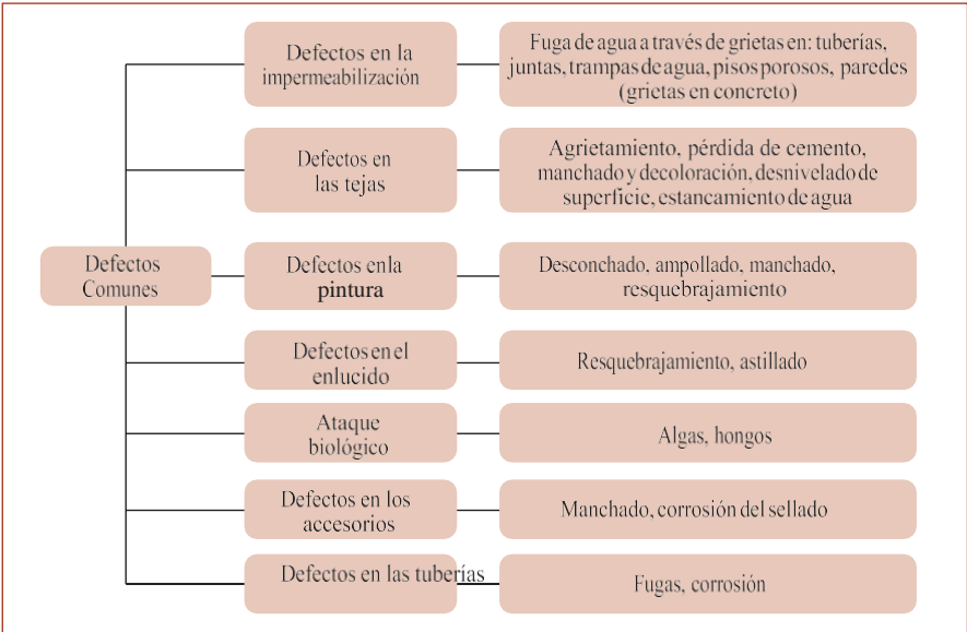
Defectos comunes en elementos de la infraestructura de los establecimientos de salud
